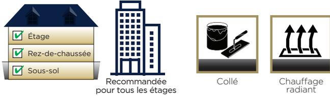
Les planchers Herringbone Mirage peuvent être installés à l'étage, au rez-de-chaussée ou au sous-sol. Il est aussi possible d'installer la plupart des essences de bois par-dessus un sous-plancher muni d'un système de chauffage radiant à l'exclusion de l'Hickory. Qu'il s'agisse d'un sous-plancher de bois ou de béton, les lames des produits Herringbone **requièrent une installation collée.**
