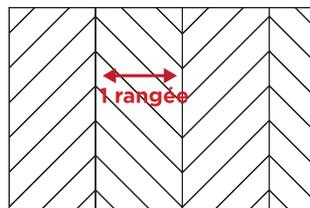
L'installation d'un plancher en motif Chevron nécessite un plus grand nombre de lames de bois que d'autres types d'installation, car les lames en périphérie de la pièce, celles adjacentes aux murs, doivent être coupées. Par conséquent, il faut prévoir une plus grande superficie de lames de bois que la superficie réelle du plancher.
